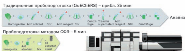
Рисунок 1: Сокращение предварительного этапа анализа с использованием системы Nexera UC
